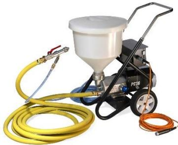
**Perfekt für Maler, Putzer, Betonbauer und Hochbau: Die MASPRA MA-PC-30 Förderpumpe** nutzt das Walkprinzip zur Materialförderung. Eine flexible Gummischeibe saugt das Material aus dem Behälter und drückt es durch das Pumpengehäuse in den Materialschlauch.
